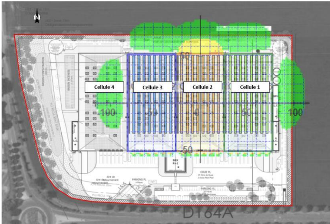
Figure 10. Modélisation des effets thermiques – Incendie généralisé de cellules de produits (palette type 1510) – cellule 1 à 3
