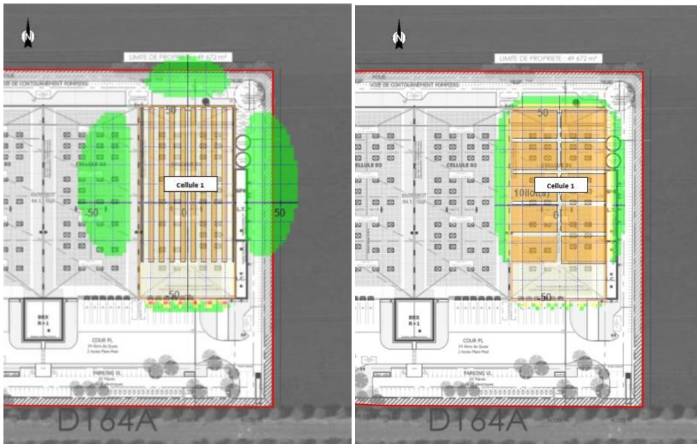
Figure 6. Modélisation des effets thermiques – Incendie de cellules de produits (palette type 2662) – cellule 1 à gauche (en racks) – cellule 1 à droite (en masse)
