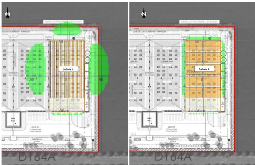
Figure 6. Modélisation des effets thermiques – Incendie de cellules de produits (palette type 2662) – cellule 1 à gauche (en racks) – cellule 1 à droite (en masse)
