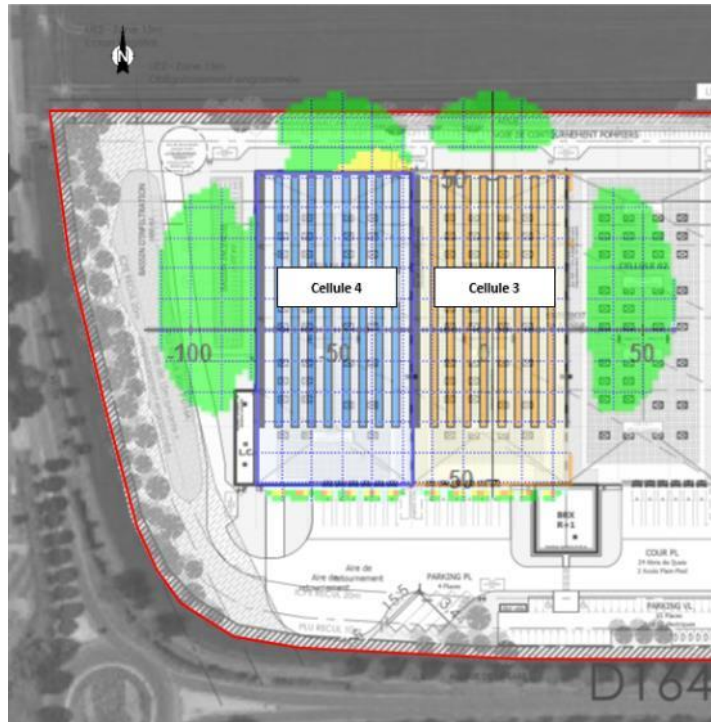
Figure 9. Modélisation des effets thermiques – Incendie généralisé des cellules 3 et 4 de produits (palette type 1510) – départ dans la cellule 4
